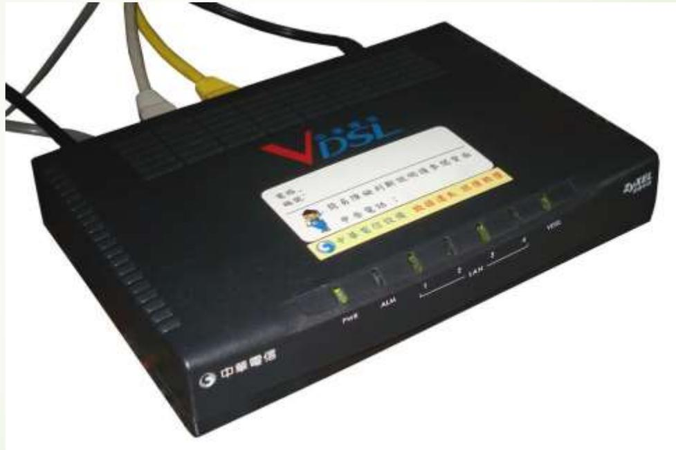
VDSL modem upotrijebljen u Taiwan-u obezbjeđuje četiri Ethernet porta interni filter za odvajanje glasovnih podataka
